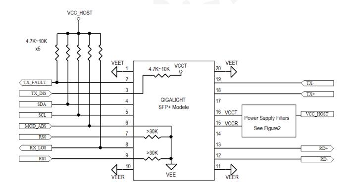
Figure 3. Host-Module Interface
