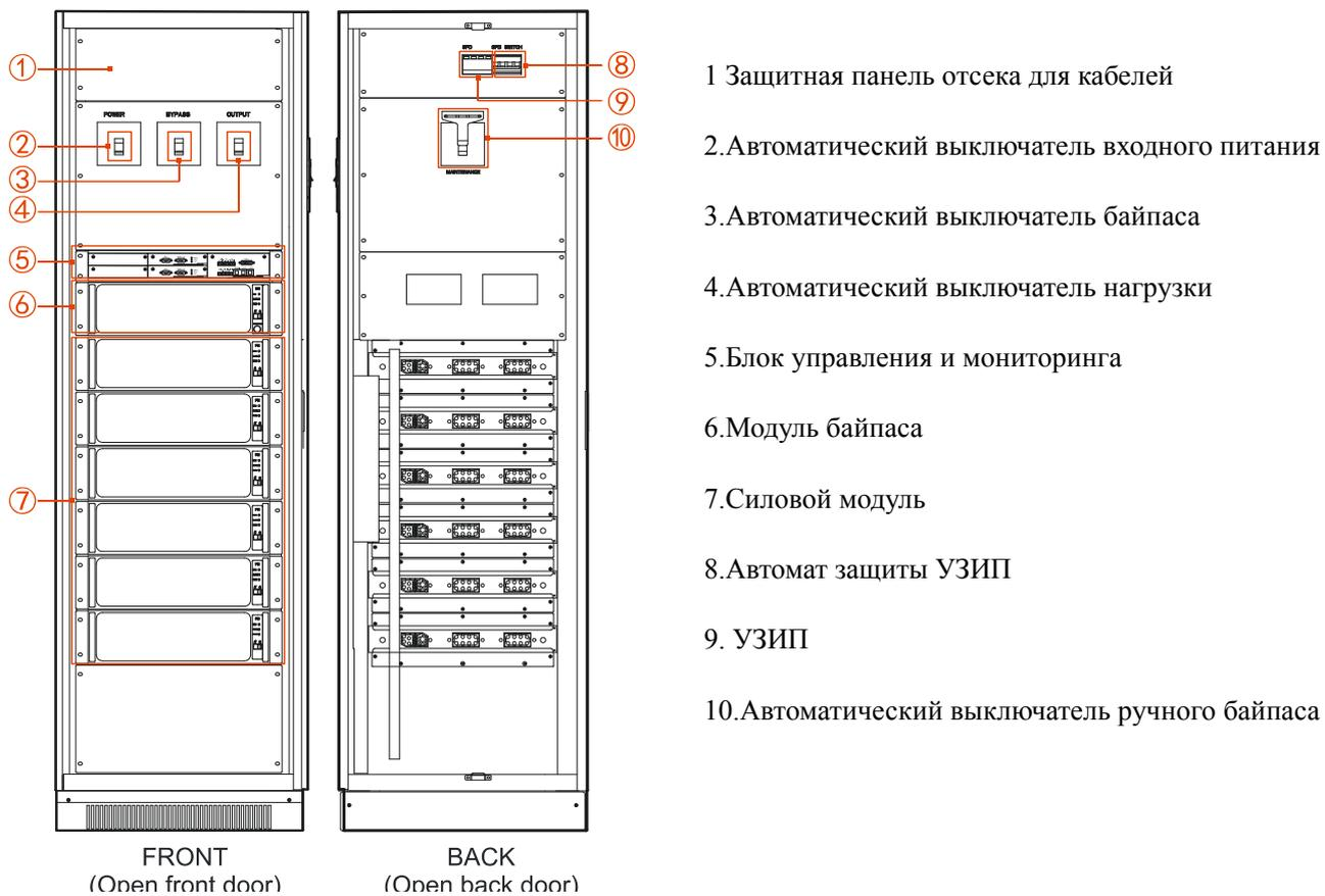
Рис. 2.9 Системное расположение MR33300 (дверь открыта)
