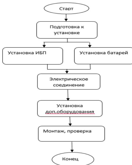
Рис.3.1 Процесс установки ИБП
