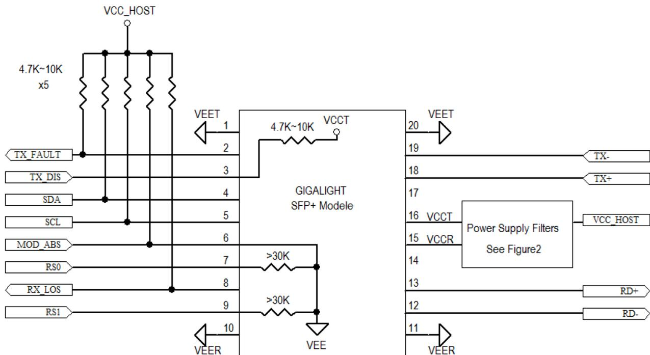
Figure3. Host-Module Interface
