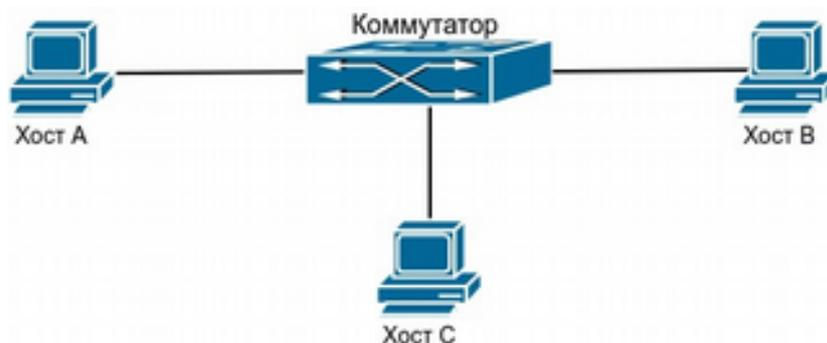
Рис. 37-1 Пример топологии для использования функции предотвращения ARP spoofing.
