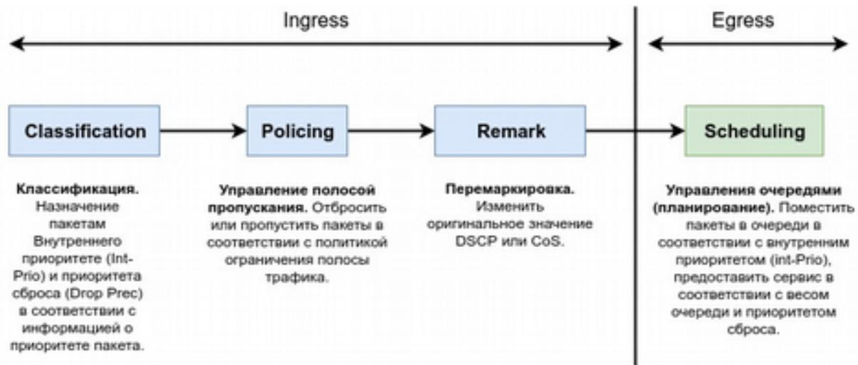
**Classification (классификация):** классифицирует трафик в соответствии с классификационной информацией пакетов и генерирует Internal Priority и Приоритет сброса. В зависимости от типов пакетов и настроек коммутатора классификация обеспечивается различным образом. **Схема ниже показывает процесс классификации.**
