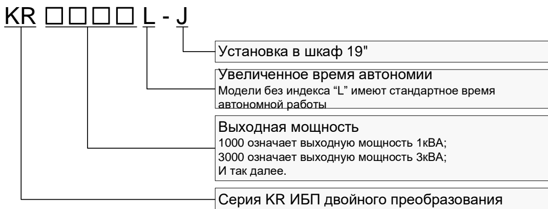
Рис 2.1 Обозначение ИБП мощностью менее 10 кВА
